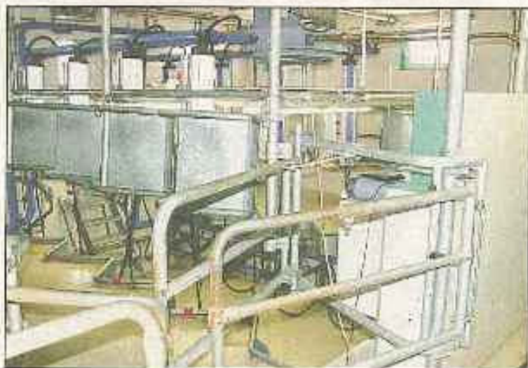
Im Doppel-Vierer-Fischgrätenmelkstand werden die Kühe von hinten gemolken. Beheizt wird er über die Hackschnitzelheizung auf dem Hof.
